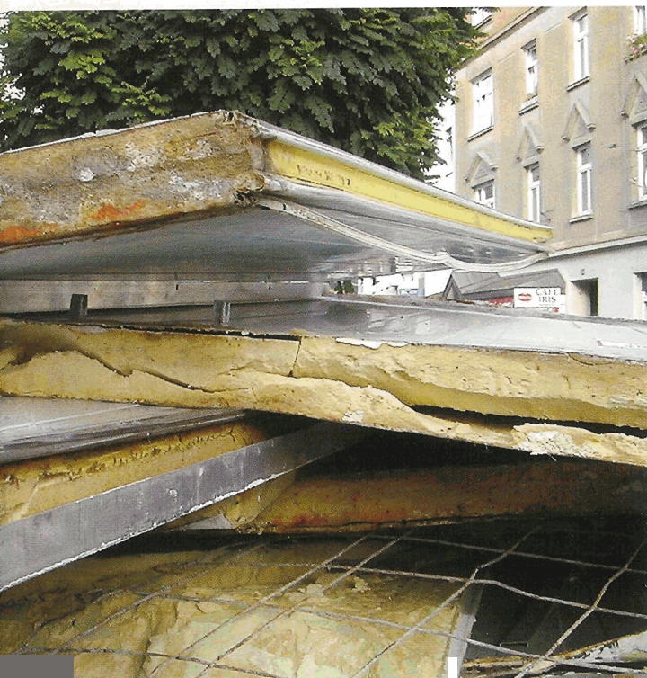
FCKW-hältige Abfälle fallen häufig bei Sanierungs- und Abbrucharbeiten an.
